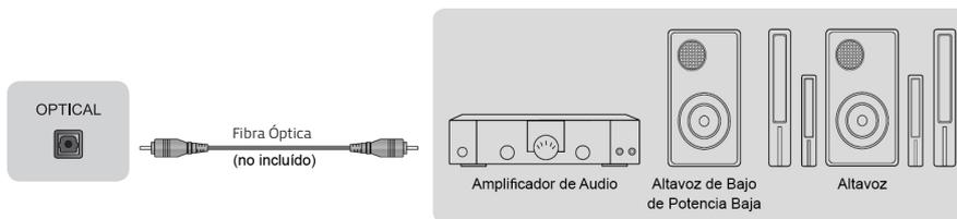
NOTA: conexión S/PDIF. El dispositivo externo debe admitir sonido digital de alta definición 5.1.
