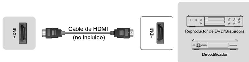
NOTA: conexión HDMI. Utilice HDMI 3 y 4 para contenido UHD hasta 60 fps y HDMI 1 y 2 para contenido UHD hasta 24 fps.
